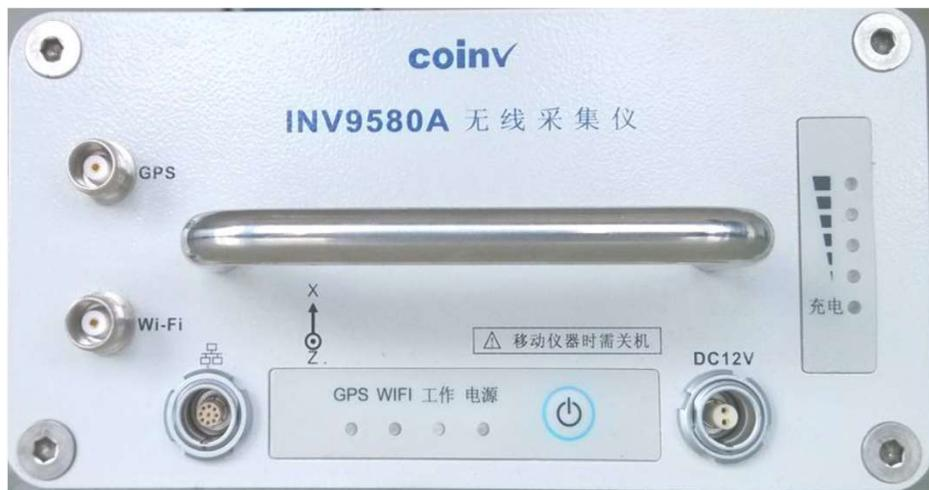
本采集仪9个指示灯，分别为4个工作状态指示灯和5个充电状态指示灯。
