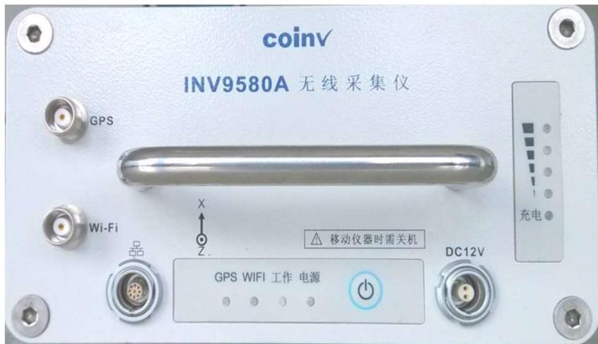
开机时，需按开机按钮0.5秒左右，开机后，电源红灯、WIFI黄灯和电量灯先亮，表示电源接通或电池电量，1分钟左右绿灯亮，表示仪器启动完毕，此时可以开始正常工作。
