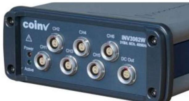
在前面板上有两个指示灯，一个为红色，一个为绿色。红灯主要显示与电源相关的信息，绿灯显示与采集工作相关的信息。开机后，红灯先亮，表示电池接通，数秒后绿灯亮，表示仪器启动完毕，此时可以开始正常工作。
