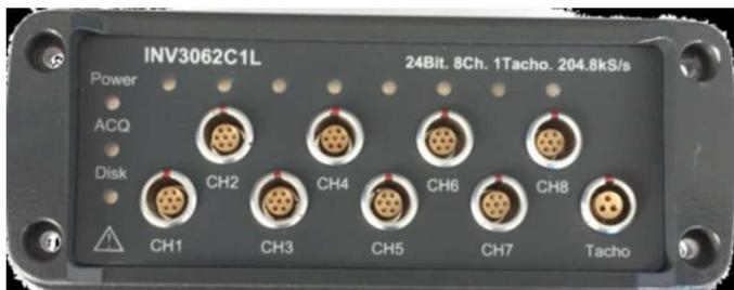
本采集仪，共有11个工作指示灯，分别是8个AI通道指示灯，1个Power电源指示灯，1个ACQ采样指示灯，1个Disk存储指示灯。
